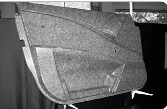
Výplň dveří automobilu kompozitním materiálem vyrobeným z konopného vlákna
